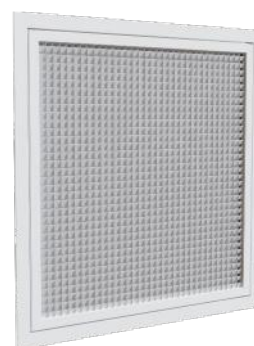
4 grilles de reprise en aluminium blanc mat avec quadrillage à 45°, de 400x200, 500x400, 600x400 et 600x600 mm
